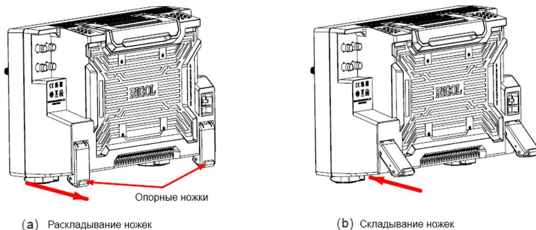
Рисунок 5.1 Выдвижение и складывание опорных ножек
