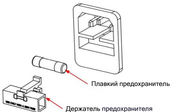
Рисунок 9.1 Замена плавкого предохранителя.
